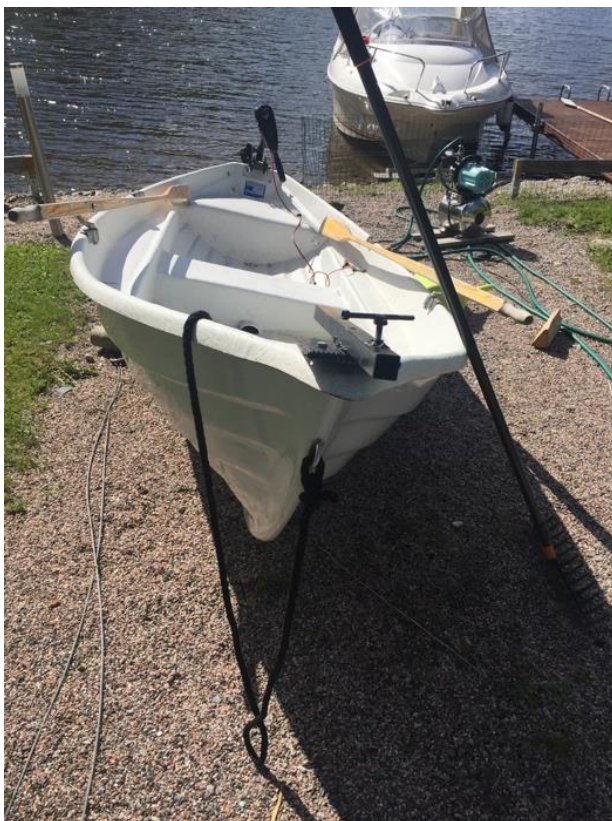
Kuva 16 Haravalaitteen kiinnitysosa jossa varren liikuttelua varten holkki
