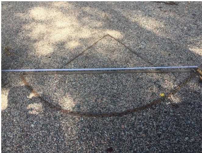
Kuva 5 Yhden veneen harjaterästankoon perustuva vetolaite
